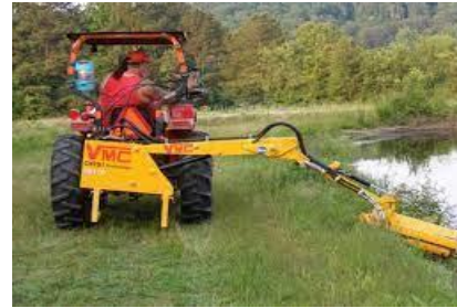
Figuras 23 & 24 Las segadoras de brazo extendido mantienen el equipo fuera de las áreas húmedas
