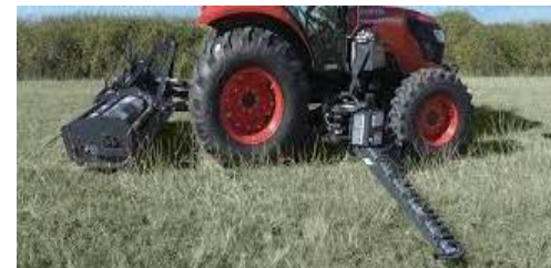
Figuras 25 & 26: Las cortadoras de césped de barra de hoz para áreas de LIMA (siglas en Ingles) permitirán cortar la vegetación de 6" o más altas
