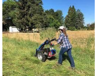
Figuras 25 & 26: Las cortadoras de césped de barra de hoz para áreas de LIMA (siglas en Ingles) permitirán cortar la vegetación de 6" o más altas
