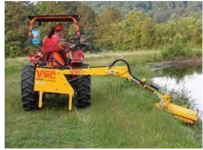
Figuras 23 & 24 Las segadoras de brazo extendido mantienen el equipo fuera de las áreas húmedas
