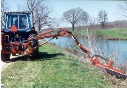
Figuras 23 & 24 Las segadoras de brazo extendido mantienen el equipo fuera de las áreas húmedas
