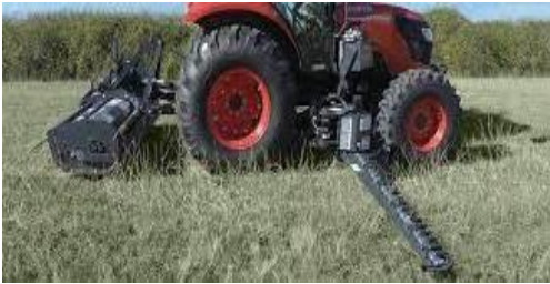
Figuras 25 & 26: Las cortadoras de césped de barra de hoz para áreas de LIMA (siglas en Ingles) permitirán cortar la vegetación de 6" o más altas
